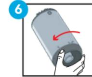
För att släcka apparaten vrid knappen mot vänster till OFF-läge. Låt apparaten svalna helt innan du ställer den undan.
