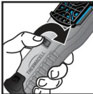
**8.** Aseta laite tasaiselle, tukevalle pinnalle siten, että ritiilä on ylöspäin. Älä koske ritiilään – se kuumenee muutamassa minutissa. Kun lopetat laitteen käytön, käänny ON/OFF-kytkin OFF-asentoon ja anna laitteen jäähtyä kunnolla. Laite on valmis varastoitavaksi.
