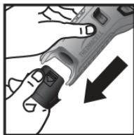
**3.** Poista laitteen pohjakansi ja kaasusäiliön korkki. Ta bort locket på apparaten samt locket på gaspatronen.
